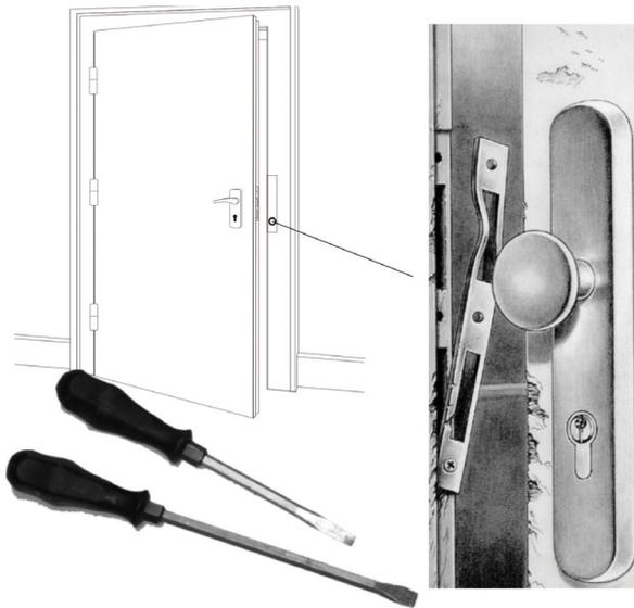
**Bild 6-3:** Schwachpunkt Schließblech
